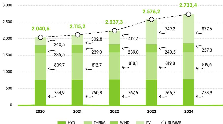
Abbildung 2: Entwicklung der installierten Leistung im Netzgebiet der Energienetze Steiermark in MW
